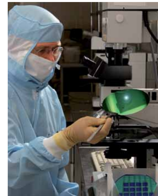
Abb. 3: Optische Prüfung eines Wafers am Mikroskop
