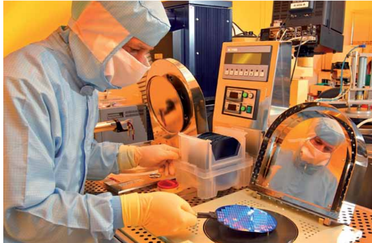
Abb. 1: Blick in den neuen Reinraum mit Ausrüstung für die Abscheidung von Fotoresist
