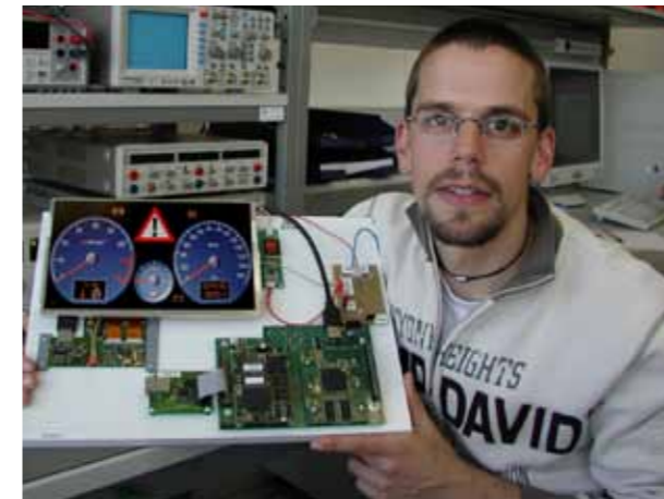
Abb. 1: Daniel Kriesten präsentiert einen Prototypen einer On-board-Einheit, die im Projekt „Generalisierte Plattform zur Sensordaten-Verarbeitung GPSV“ entwickelt wurde.
