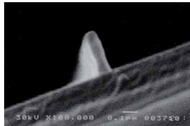
Abb. 2: SEM-Aufnahme der Gateelektrode eines Sub-50nm-MOS-Transistors
