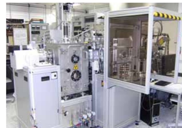
Abb. 1: Anlagen zur Beschichtung von Wafern mittels Elektronenstrahlbedampfung
